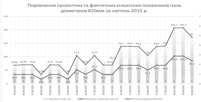
Рис 4. Визначення та аналіз проектних та фактичних кількісних показників при влаштуванні буронабивних паль
