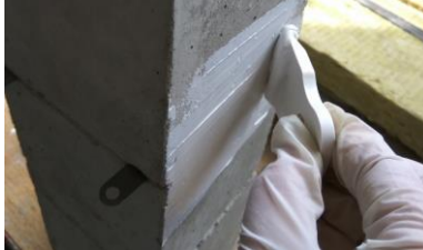
Рис. 1. Обмашування дослідного зразка акриловою шпаклівкою
