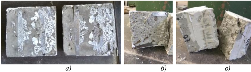
Рис. 4. Вид руйнування адгезійних з'єднань: а) – адгезійне з'єднання; б) – змішане з'єднання; в) когезійне з'єднання
