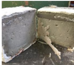
Рис. 5. Спучення розчинів «Едмок ін'єкційний» і «Консолід 1» при їх контакті в зоні введення
