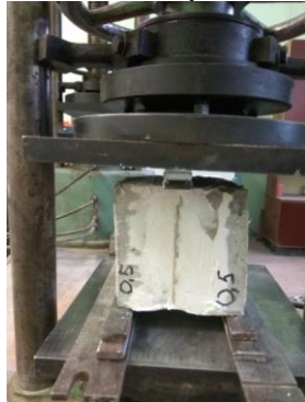
Рис. 3. Схема прикладання руйнівного зусилля до дослідного зразка
