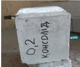
Рис. 2. Положення на дослідному зразку штуцера для випуску зайвого повітря та ін'єкційної голки для подачі розчину
