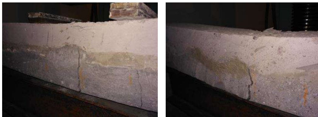
Рис. 6. Характер руйнування відновлених балок №3 та №4
