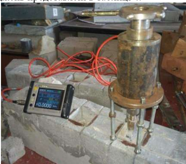
Рис. 7. Визначення міцності зчеплення шарів конструкції
