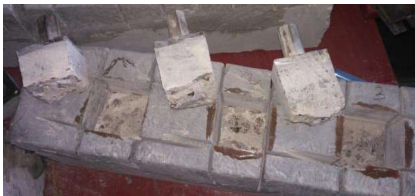
Рис. 8. Вид руйнування зразків, які досліджували на міцність зчеплення з основою
