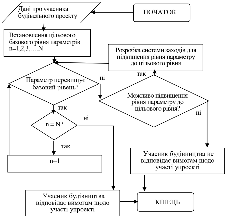
Рис.1. Схема алгоритму оцінювання рівня цифрового розвитку учасників будівництва (розроблено автором, фрагмент)
