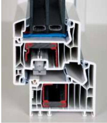
Рис. 2. Віконна система з трьома контурами ущільнення, двокамерним склопакетом та армуванням с терморозривом (фотографія автора)
