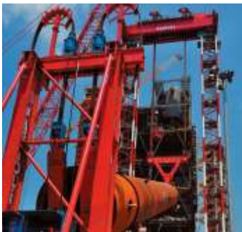
Рис. 5. Щогловий гідравлічний тросовий гідропідйомник FAGOLI
