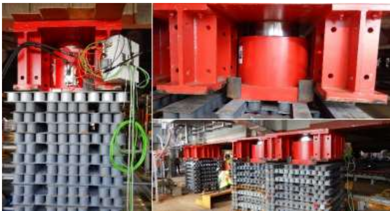
Рис .6. Гідравлічний домкрат двосторонньої дії FAGIOLI 600
