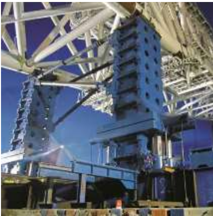
Рис. 3. Стаціонарні гідропідйомні модулі Sarens Group, ENERPAC та Fagoli
