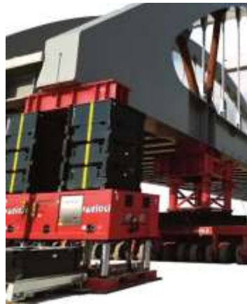
Рис. 3. Стаціонарні гідропідйомні модулі Sarens Group, ENERPAC та Fagoli
