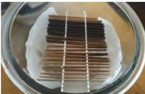
Рис. 7. Витримування досліджуваних зразків у вологому середовищі.
