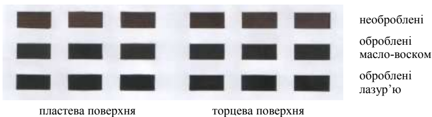
Рис. 11. Зразки деревини граба модифіковані за температури 220 °С упродовж 10 год, оброблені маслом-воском та лаком
