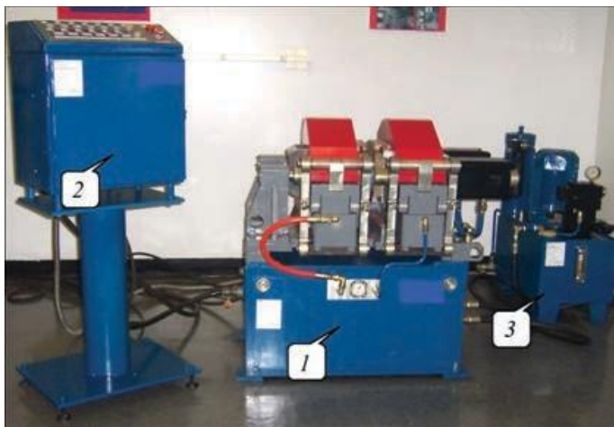
Рис. 2. Установка МД103: 1 – зварювальна машина; 2 – шафа з мікропроцесором; 3 – насосна гідравлічна станція.
