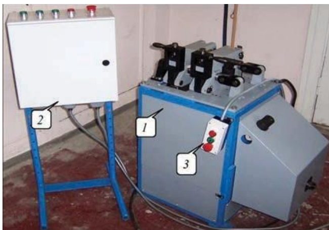
Рис. 1. Установка МД101: 1 – зварювальна машина; 2 – шафа з мікропроцесором; 3 – пульт управління
