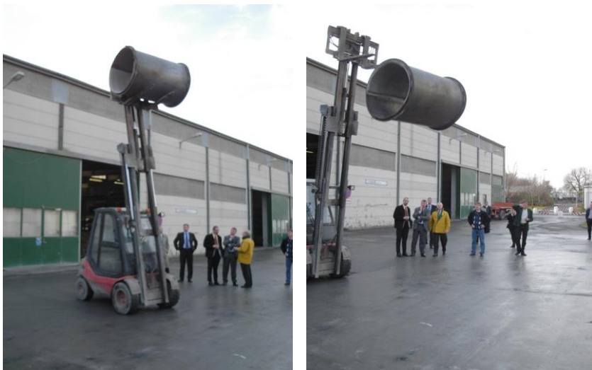
Рис. 2. Випробовування на міцність фрагментів труб футерованих фібро-бетоном
