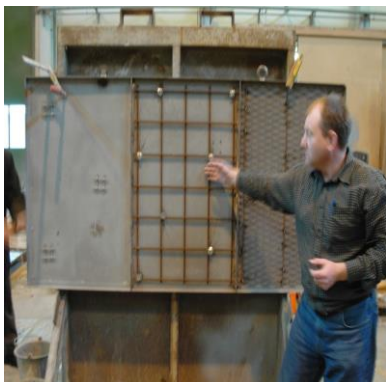
Рис. 1. Експериментальні зразки анкерування бетонної футеровки до металу
