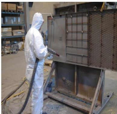
Рис. 1. Експериментальні зразки анкерування бетонної футеровки до металу
