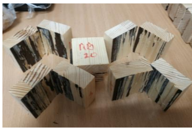
Рис. 4. Руйнування зразків під час дослідження межі міцності клеєвого шва: а – основа МДФ; б – основа меблевий щит
