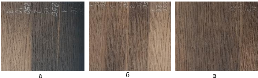
Рис. 1. Зразки дубового шпону після термомодифікування за температури 250 °С протягом: а – 600 с; б – 1200 с; в – 1800 с
