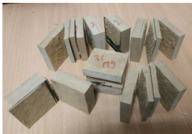
Рис. 3. Руйнування зразків під час дослідження межі міцності клеєвого шва: а – основа ДСП; б – основа МДФ
