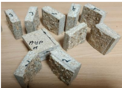
Рис. 3. Руйнування зразків під час дослідження межі міцності клеєвого шва: а – основа ДСП; б – основа МДФ
