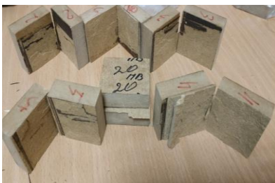
Рис. 4. Руйнування зразків під час дослідження межі міцності клеєвого шва: а – основа МДФ; б – основа меблевий щит
