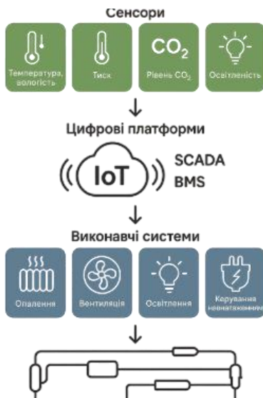
Рис. 1. Архітектура цифрового моніторингу енергоадаптивного об'єкта (розроблено автором на основі [2])
