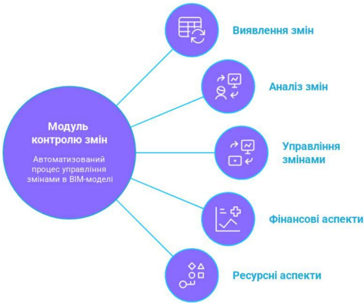
Рис. 5. Конструкція модуля контролю змін у BIM з інтеграцією до ERP-системи (розроблено автором на основі [15])
