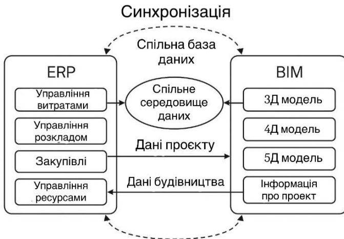
Рис. 2. Концептуальна схема з'єднання ERP та BIM у спільному середовищі даних (розроблено автором на основі [5])
