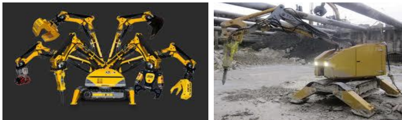
Рис. 1. Роботизована демонтажна система Brokk 200
