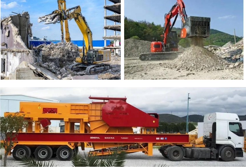
Рис. 2. Машини для демонтажу та рекуперації будівельних відходів
